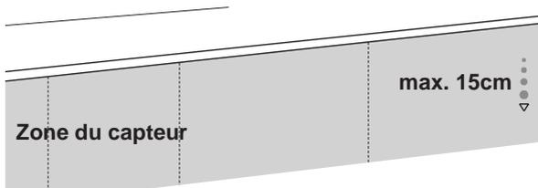
Pour tous les mouvements effectués sous les 15 cm, le capteur ne réagit pas.
