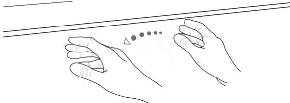
2. Węższy strumień aktywuje się, umieszczając dłoń pod czujnikiem na więcej niż 1 sekundę. Strumień światła zostanie aktywowany w miejscu, w którym znajduje się dłoń.
