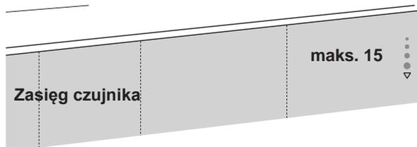
Czujniki nie reagują na ruch wykonywany w odległości większej niż 15 cm.
