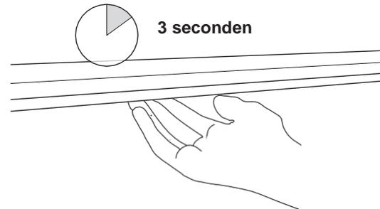
Door je hand onder de sensor door te halen "scroll" je door het beschikbare kleurenpallet. Je kunt vooruit en achteruit scrollen door de hand ofwel van links naar rechts ofwel van rechts naar links onder de sensor te swipen.
