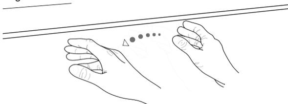
2. Un faisceau plus étroit est activé en tenant votre main sous la bande de détection pendant plus d'une seconde. Le faisceau lumineux ne sera activé qu'à l'endroit où se trouve votre main.
