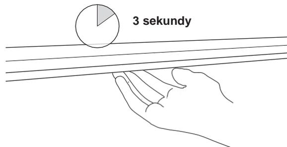
Przesuwając dłoń pod czujnikiem, można „przejrzeć” dostępne kolory. Można je przeglądać do przodu i do tyłu, przesuwając dłoń pod czujnikiem z lewej strony na prawą lub z prawej na lewą.
