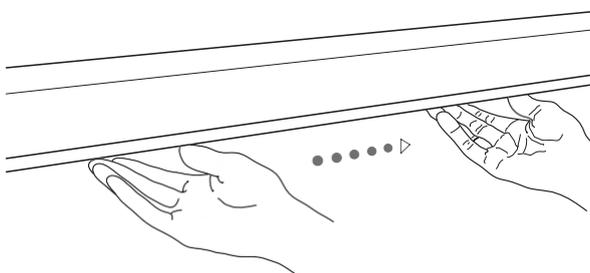
Innym sposobem na przesunięcie strumienia światła jest przytrzymanie dłoni pod czujnikiem w miejscu, gdzie ma się znaleźć strumień. Strumień światła przesunie się w stronę dłoni.
