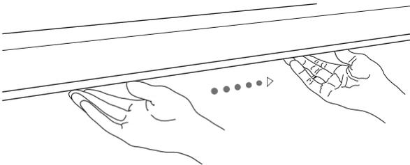
Eine andere Möglichkeit, den Lichtstrahl zu bewegen, besteht darin, die Hand an die Stelle unter den Sensor zu halten, an der Sie den Lichtstrahl bewegen möchten. Der Lichtstrahl wird dann auf Ihre Hand gerichtet.
