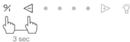
Funkci lze zapnout současným přidržením tlačítek a po dobu 3 sekund. 2. a 3. LED kontrolka 3krát zabliká pro potvrzení (spotřebič musí být vypnutý).
