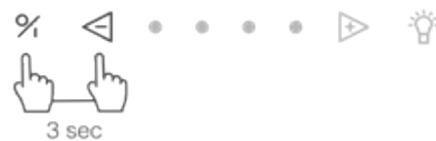
Esta función puede activarse pulsando las teclas y simultáneamente durante 3 segundos. El segundo y tercer indicador LED parpadearán 3 veces a modo de confirmación (el electrodoméstico debe estar apagado).
