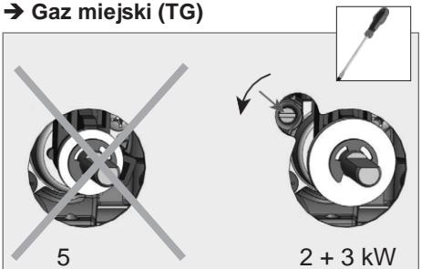
**NL** - Draai de stelschroef van de gaskraan een 1/2 slag naar links (open).
