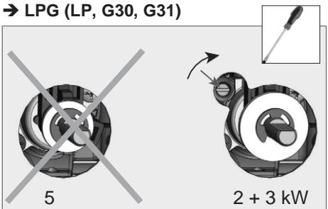
**NL** - Draai de stelschroef van de gaskraan rechtsom volledig dicht.
